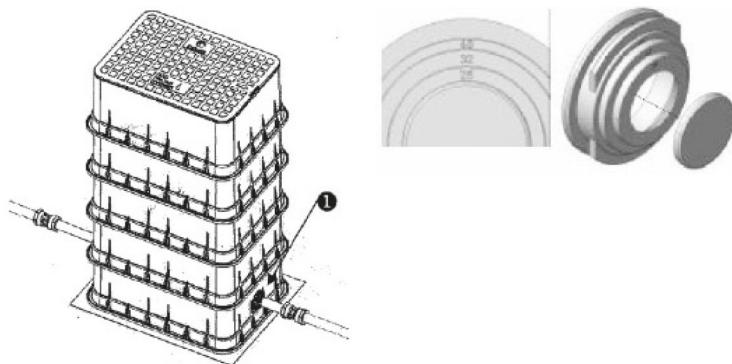
**UPOZORNĚNÍ! Odvzdušnění/odvodnění provádějte výhradně přes ovládací ventilek, NE klíčem přes závit!**
